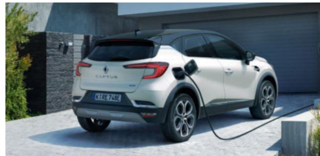
• Voll aufgeladen in 5 Stunden an einer 10- bis 16-Ampère-Steckdose bzw. 3 Stunden an einer Wallbox oder öffentlichen Ladestation.
