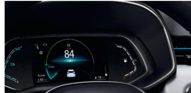
• Mit dem E-Tech Hybridantrieb können Sie durch die Energierückgewinnung beim Verlangsamen und Bremsen bis zu 80% der Strecken in der Stadt rein elektrisch fahren und den Kraftstoffverbrauch um bis zu 40% senken.
